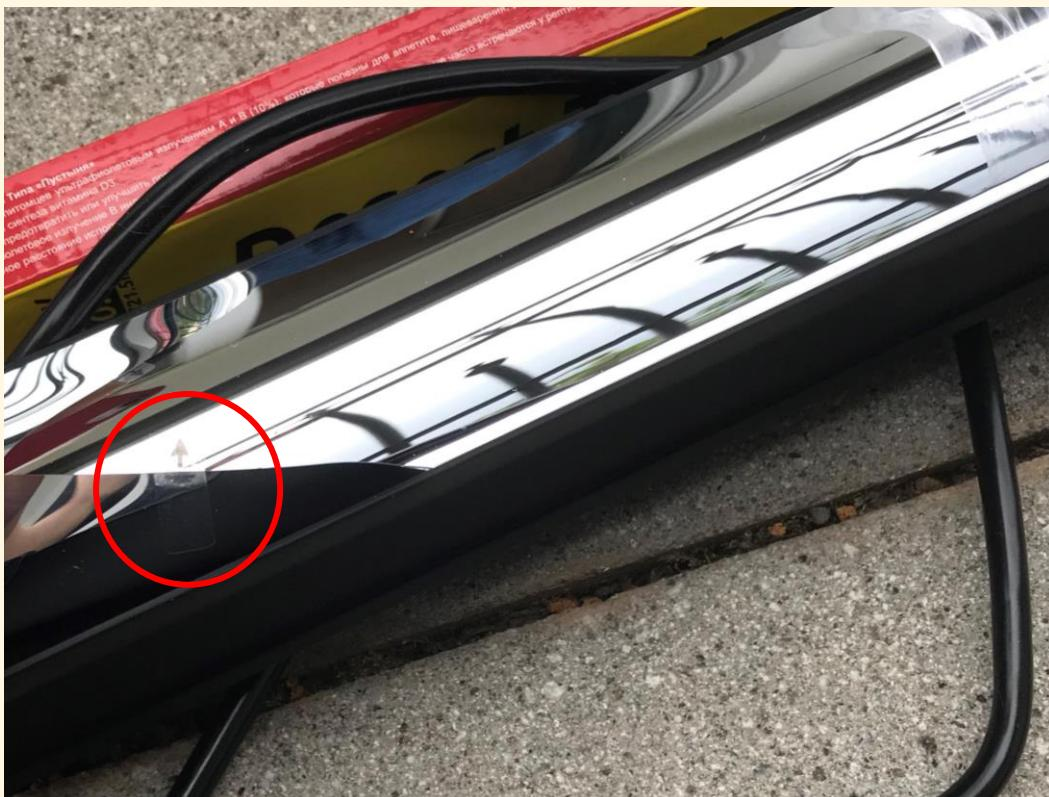
Obwohl beide Seiten für das bloße Auge nahezu identisch aussehen, reflektiert nur eine von beiden Seiten UV. Es besteht das Risiko, dass die Reflektorfolie falsch herum in das Lampengehäuse eingesetzt wird, entweder vom Anwender oder vom Hersteller. Leuchten mit herstellerseitig falsch herum eingesetztem Reflektor wurden bereits bei anderen Marken entdeckt.
