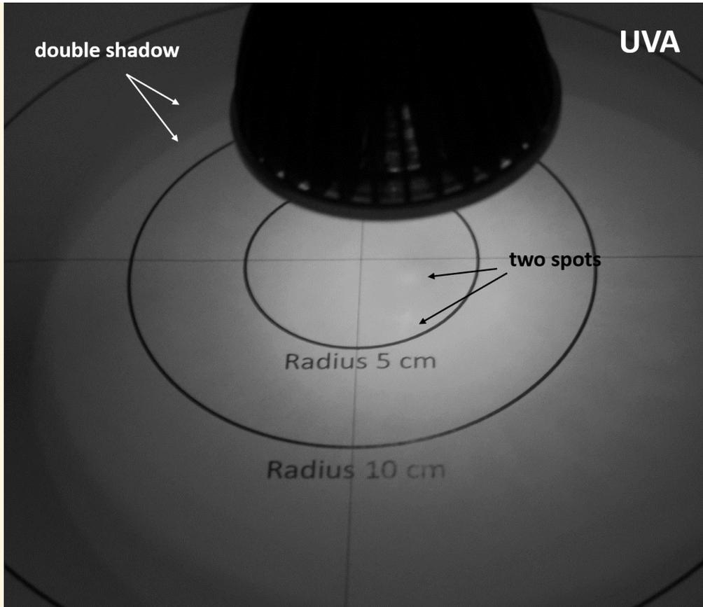
Bei der UVA-Ausleuchtung sieht man zwei Spots und zwei Randschatten durch die beiden UVA-LEDs. Dieses Foto wurde in 5 cm Abstand zur Lampe aufgenommen und die Lampe leicht seitlich verschoben, so dass die Spots etwas entfernt von der gedruckten Linie und dadurch besser sichtbar sind. Die zwei Schatten der beiden UVA-LEDs werden sich mit dem dazu verschobenen Schatten der sichtbaren LED überlagern, so dass es aus Reptiliensicht zu farbigen Rändern kommen wird.
