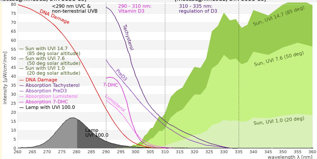
Die verbaute UVB/UVC-LED mit Maximum bei knapp 280 nm ist in keinsten Weise sonnenähnlich. Es wird nahezu keine terrestrische UVB-Strahlung abgestrahlt, sondern nicht-terrestrische UVB-Strahlung und UVC-Strahlung. Ich befürchte stark schädigende Wirkung auf die Haut und Augen der bestrahlten Tiere.
