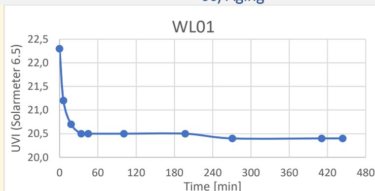
Die UVB-Strahlung zeigt in den ersten 7 Betriebsstunden keine Alterung. Ein leichter Rückgang um knapp 10% des UV-Index in den ersten Minuten durch das Aufwärmen der Lampe ist zu sehen, dieser ist aber reversibel. Nach dem
