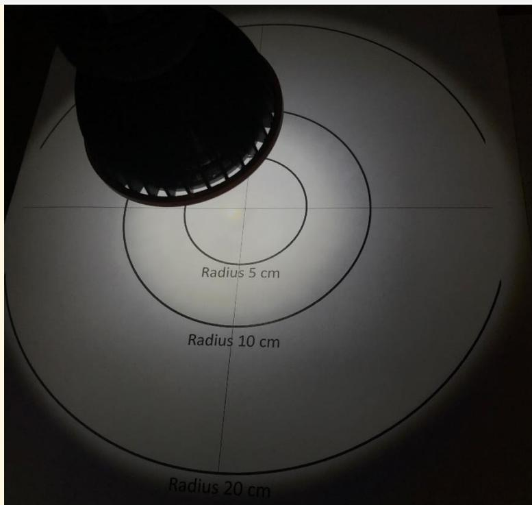
Die Ausleuchtung ist sehr homogen mit einem leicht bläulichen Punkt in der Mitte. Dies wird von der blauen Primär-LED verursacht die stärker geradeaus durch den Leuchtstoff strahlt.
