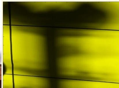
Die Überlagerung der beiden Bilder ergibt dann Grautöne, wenn die UVA-LEDs und VIS-LEDs ihre Schatten an den gleichen Positionen erzeugen. Anderfalls sind die Schatten blau und gelb gefärbt (oder UVA-farbig und die Komplementärfarbe zu UVA)
