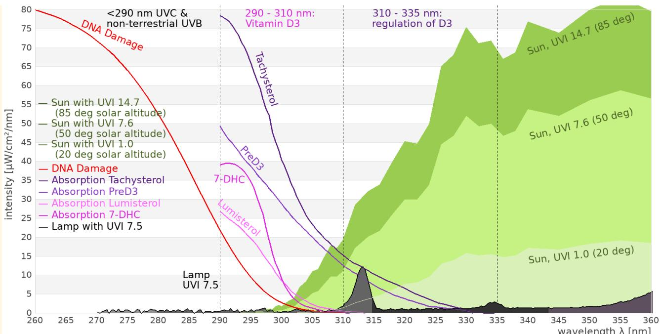
Die Grafik zeigt, dass nahezu neben Messrauschen keine UV-Strahlung im Bereich 290-310 nm vorhanden ist. Die Quecksilberemissionslinie bei 313 nm wird voraussichtlich nicht zur Vitamin D3 Bildung beitragen. Es ist aber auch keine schädliche Strahlung vorhanden.
