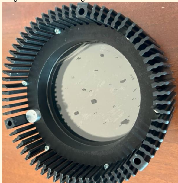
Davor befindet sich eine Glasküvette mit dem Hydrofilter. Der große Kühlkörper zeugt davon, wie viel Infrarotstrahlung in der Flüssigkeit absorbiert wird. Bei meinem Strahler ist die Küvette nicht mehr vollständig gefüllt und müsste ausgetauscht werden. Außerdem schwimmen kleine Partikel in der Flüssigkeit. Das Licht dieser Lampe wird also schwächer – aber weiterhin zum großen Teil – wassergefiltert sein.
